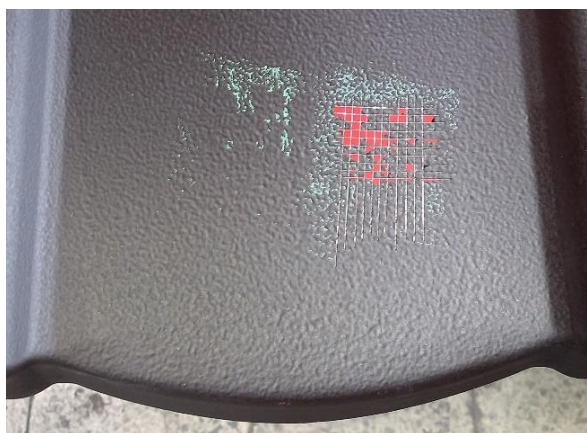
Obr. č.: 3.4.3.2 Negatívny výsledok testu - nedostatočná príľnavosť.
