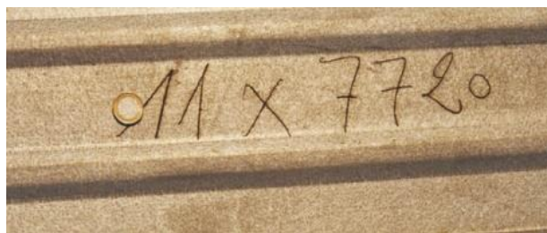
Obr. č.: 2.4.2 Povlaky na báze Zn majú "samohojivú" schopnosť čo znamená, že na škrabancoch a strižných hranách po odkrytí oceleového jadra nevzniká červená vrstva hrdze, ale ochranná hnedastá patina, ktorá zastaví koróziu na veľmi dlhú dobu.
