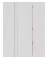
Obr. č.: 2.5.2.3 Porovnanie po škrabancoch v teste po 1000 hod. Povlak Z 275 g/m 2 je viac znehodnotený ako ZM 120 g/m 2 .
