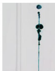
Obr. č.: 2.5.2.3 Porovnanie po škrabancoch v teste po 1000 hod. Povlak Z 275 g/m 2 je viac znehodnotený ako ZM 120 g/m 2 .
