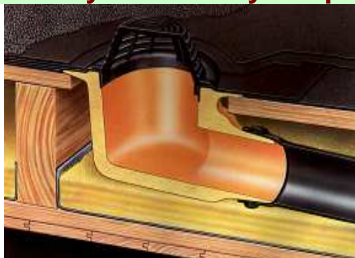
Osazení mezi stropními nosníky
