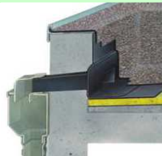
Odvodnění vnějším svodem ( po fasádě )
