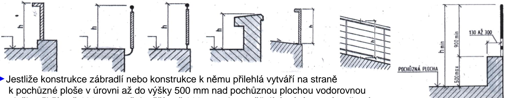
► Jestliže konstrukce zábradlí nebo konstrukce k němu přilehlá vytváří na straně k pochůzné ploše v úrovni až do výšky 500 mm nad pochůznou plochou vodorovnou plošinu širší než 130 mm, avšak užší než 300 mm, tj. umožňující stání, musí celková výška zábradlí (  $h$  ) převyšovat úroveň plošiny nejméně o 900 mm ( obr.2 )
