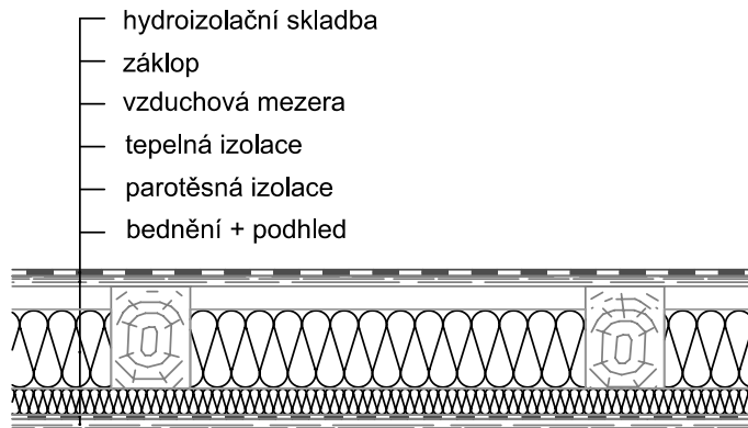
Obr.č. 8 - Dvouplášťová střechy se zakrytými trámy.
