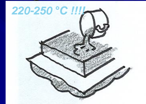
Pod litý asfalt - silniční i železniční mosty
