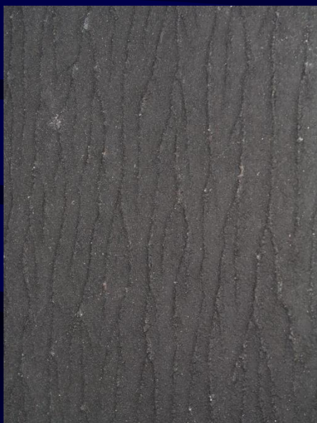
Aktivní oboustranná povrchová úprava zajišťující spojení s betonem
