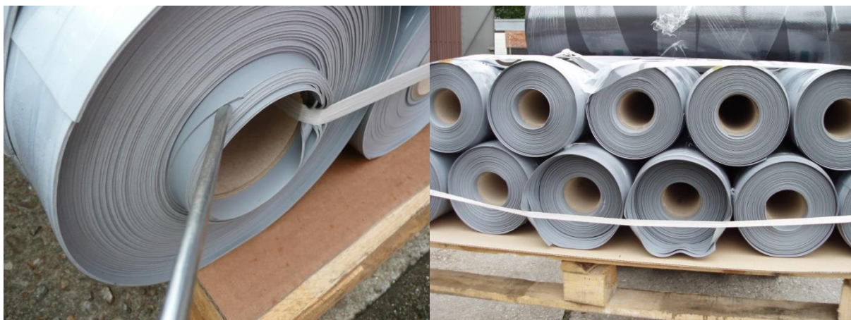
Obr. č. 83 – Špatně balená a špatně dopravená fólie
