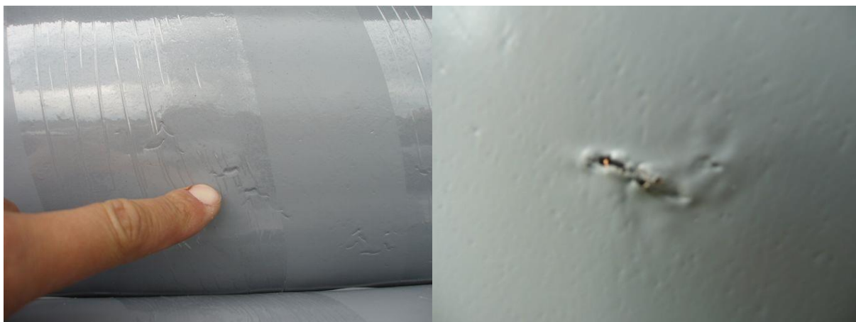
Obr. č. 86 – Stopy po neočištěných válcích výrobní linky
