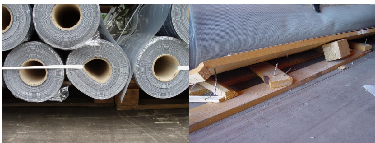
Obr. č. 84 - Deformace rolí uložených na paletě
