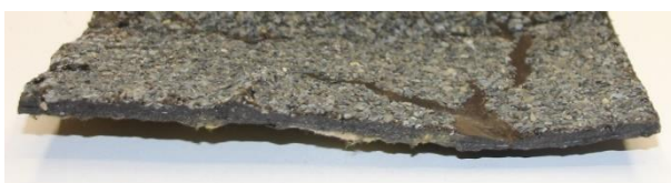
Obr. č. 192 – Řez pásem, který je postižen krokodýlingem
