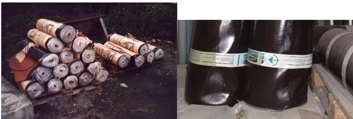
Obr. č. 178 – V důsledku tohoto skladování dochází k deformaci skladovaných rolí na pravém obrázku se deformace nazývají „sloní noha“
