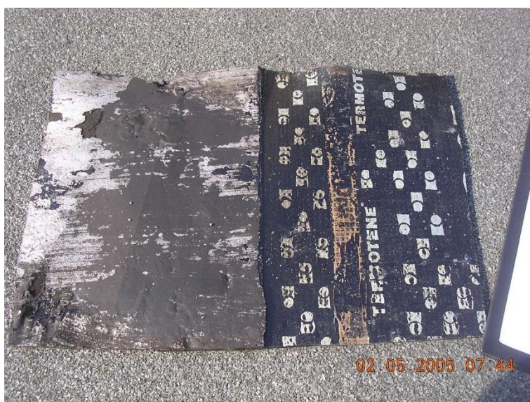
Obr. č. 211 – Snímek zachycuje nespálenou „spalnou“ fólii, tzn. že pás byl volně položen a nebyl s podkladem vůbec spojen
