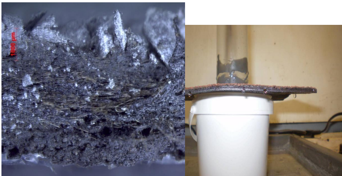
Obr. č. 186 – Nehomogenita asfaltového hydroizolačního pásu, která vede k lokální netěsnosti tohoto materiálu
