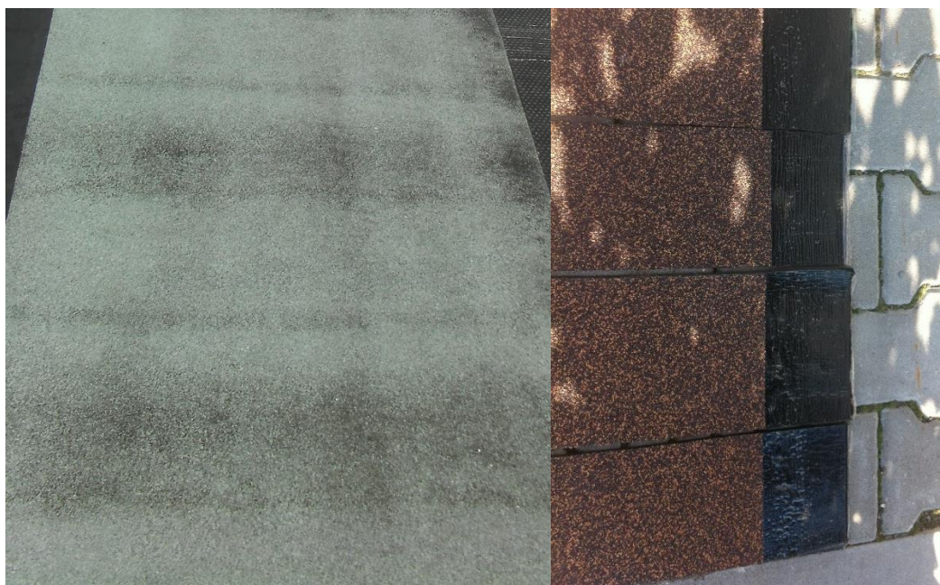
Obr. č. 180 - Příčinou zachycené poruchy je nerovnoměrný tlak přítlačného válce (možná i elipsovité tohoto válce)
