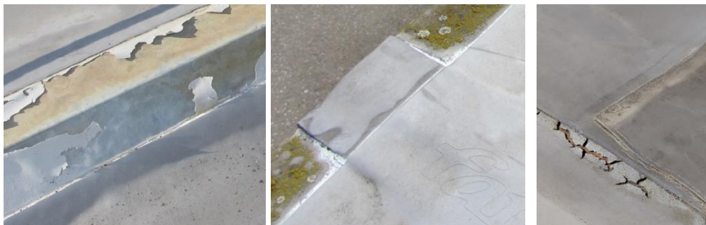
Obr. 1: Degradace a delaminace PVC vrstvy u starých typů poplastovaných plechů
